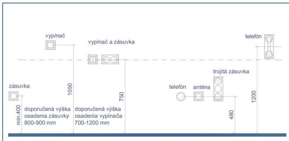
Obr. 13 – Vhodné výšky osadenia ovládacích prvkov a mechanizmov
