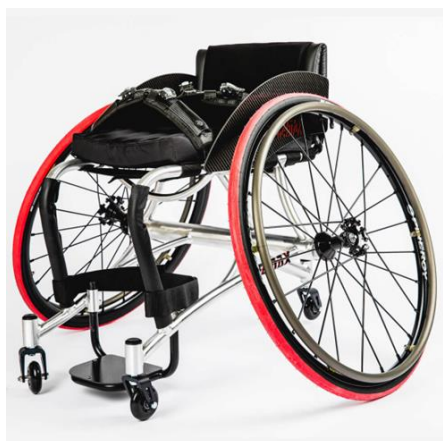
Obr. 18 - Rázvor kolies športového vozíka je cca 1000 mm
