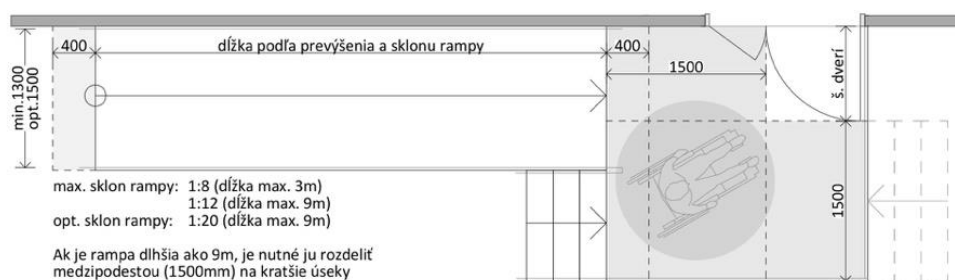
Obr. 1 Riešenie exteriérovej rampy bytového domu
