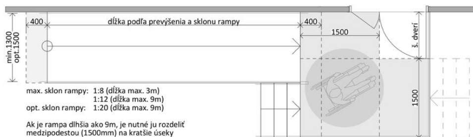
Obr. 1 Riešenie exteriérovej rampy bytového domu
