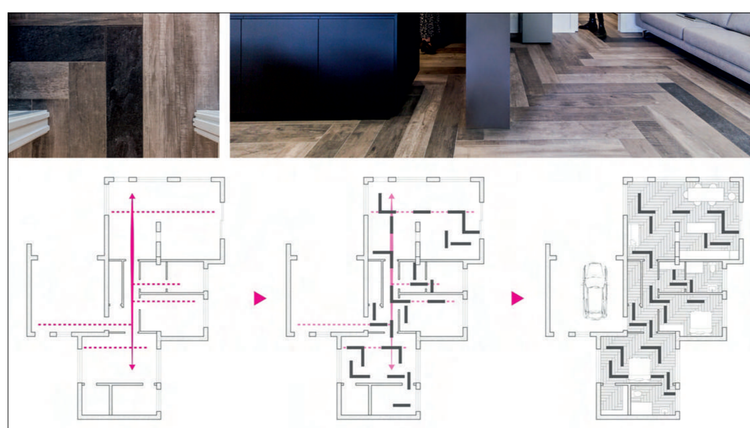
SÚKROMNÝ INTERIÉR INTERIÉROVÉ PODLAHOVÉ RIŠENIE PRE ĽUDÍ S PORUCHAMI ZRAKU PRE LEPŠIU ORIENTÁCIU V PRIESTORE
