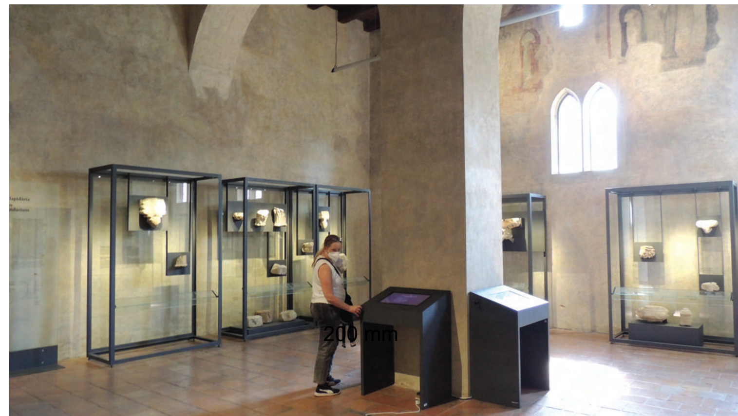
INFORMAČNÉ PULTY SÚ V ZNÍŽENEJ VÝŠKE A UMOŽŇUJÚ ZASUNUTIE NÔH. INFOCOUNTERS ARE AT A REDUCED HEIGHT AND ALLOW LEGS TO TUCK UNDER.
