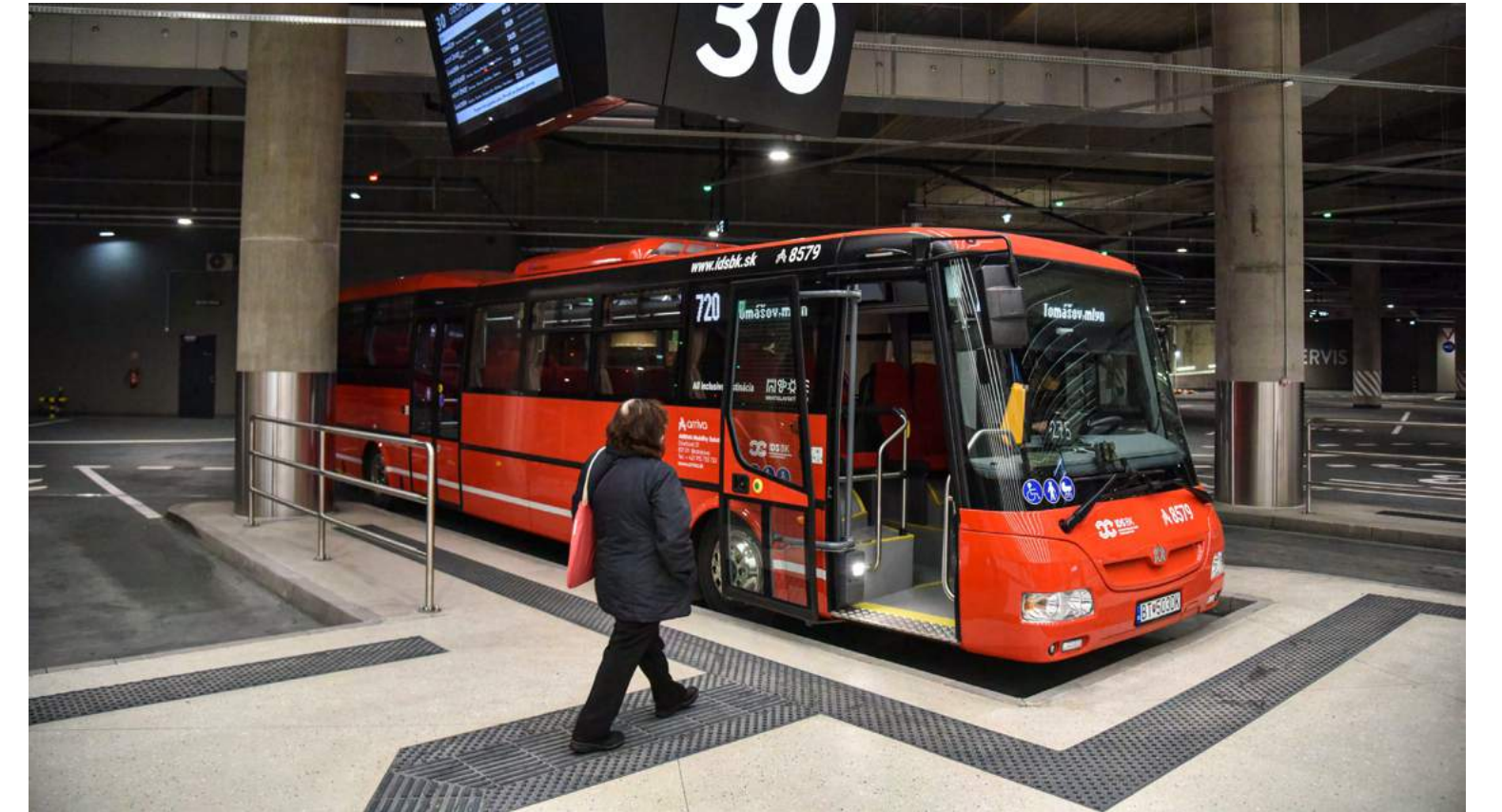
AUTOBUSOVÉ NÁSTUPIŠTE S NÍZKOPODLAŽNÝM AUTOBUSOM VÝRAZNÉ OZNAČENIE ČÍSLA NÁSTUPIŠŤA, POUŽITIE TAKTILNÝCH POVRCHOV
